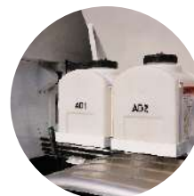
Contenedores de aditivo alto y bajo flujo
